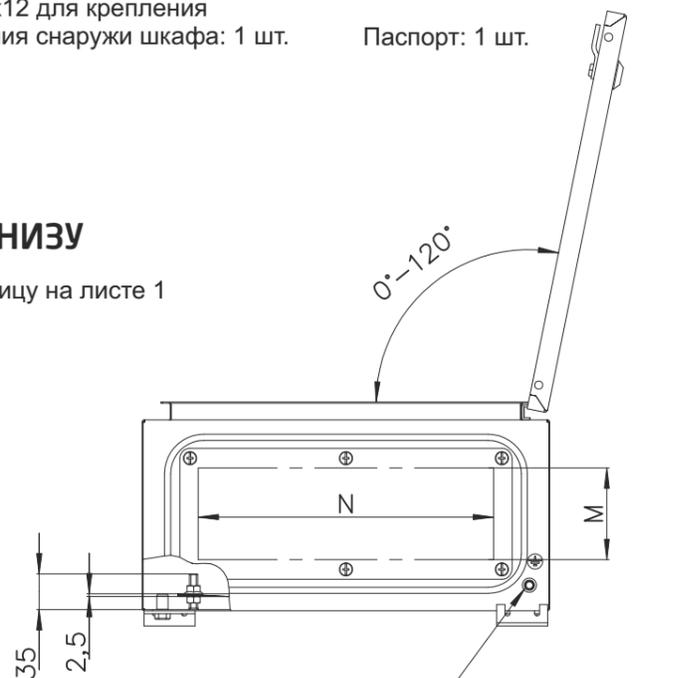
Элемент для подключения заземления. Винт M8
