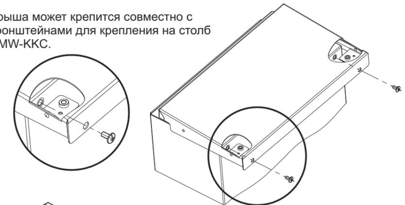
8 Также имеется возможность дополнительного крепления через крышу шкафа. Для этого требуется просверлить отверстия диаметром 8,5 мм по имеющейся разметке в крыше шкафа.
