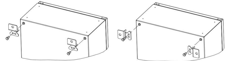
5 Закрепите шкаф на стене через отверстия в кронштейнах диаметром 9 мм. При фиксации шкафа без использования кронштейнов, блокируйте отверстия для установки кронштейнов с внутренней стороны шкафа, используйте винты M6x12.
