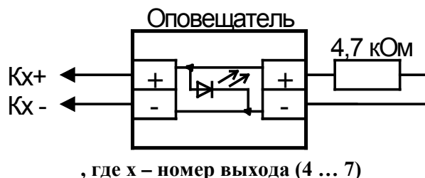
Рисунок 2.4. Схема подключения одного полярного оповещателя (исполнительного устройства) к выходу прибора
