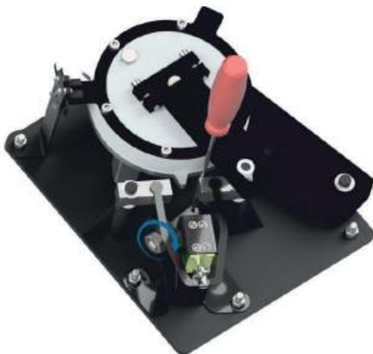
Рисунок 12.4.1 – Регулировка натяжения пружины доводчика.
