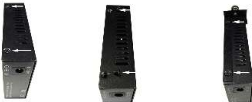
Рис. 4 Установка крепления под винт на корпус медиаконвертера
