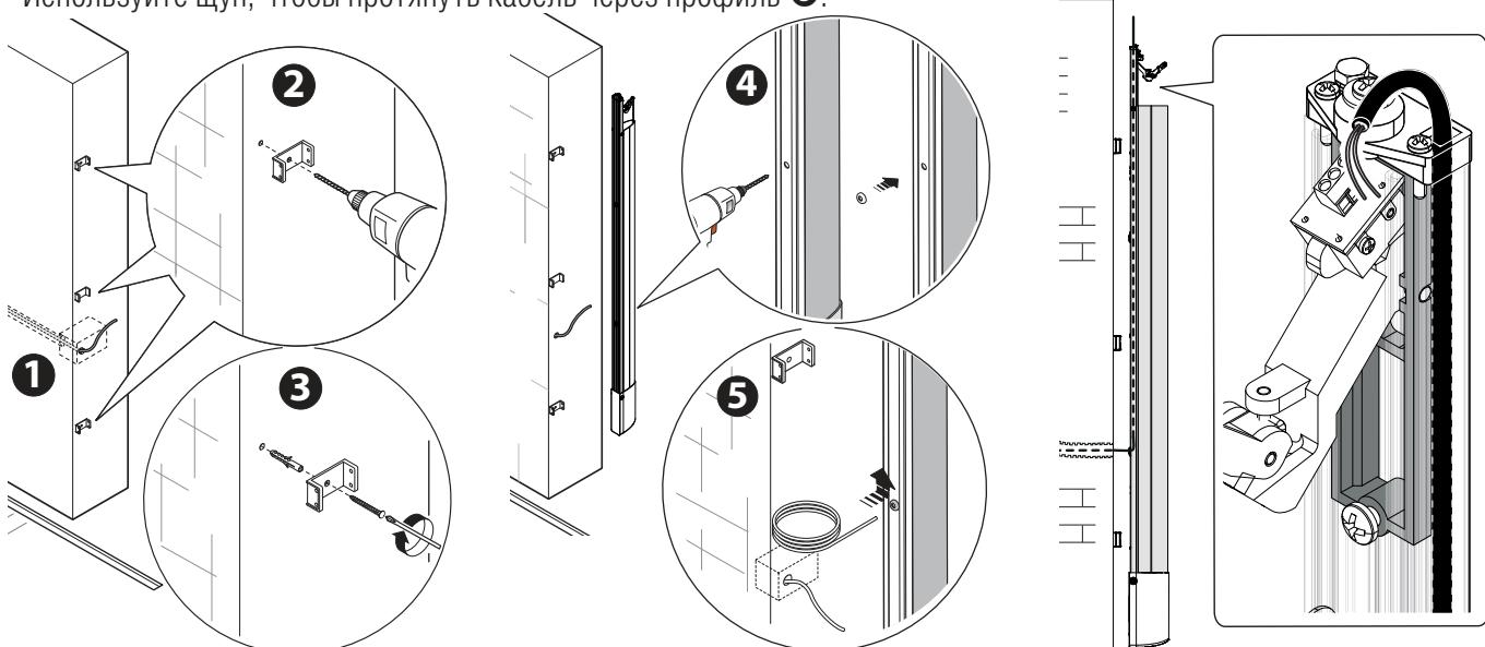
Установите чувствительный профиль на кронштейны (так, чтобы блок микровыключателей был обращен вверх), просверлите отверстия  $\varnothing$  2,5 мм с двух сторон профиля ⑥ и прикрепите его винтами UNI 6954  $\varnothing$  2,9x13 ⑦.
