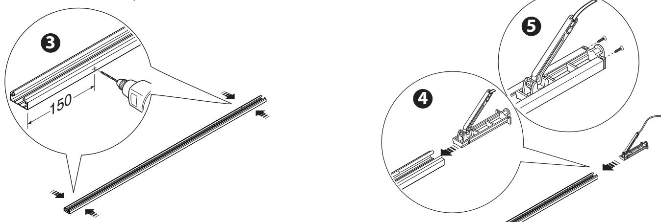
Вставьте резиновый профиль в алюминиевый и придвиньте его вплотную к устройству зацепления троса **6**.
