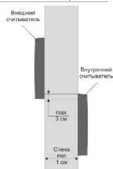
Рисунок 4. Крепление считывателей с разнесением по вертикали
