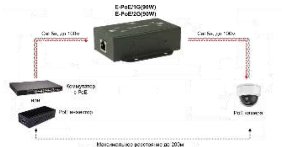
Рис.4 Схема подключения PoE удлинителей E-PoE/1G(90W), E-PoE/2G(90W)
