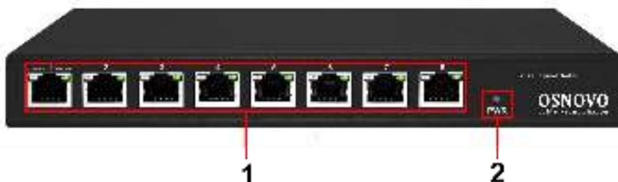
Рис. 2 Коммутатор SW-8D-1, разъемы и индикаторы на передней панели
