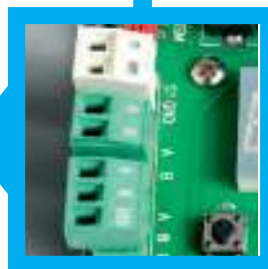
Цветные клеммные колодки упрощают подключения и диагностику.
