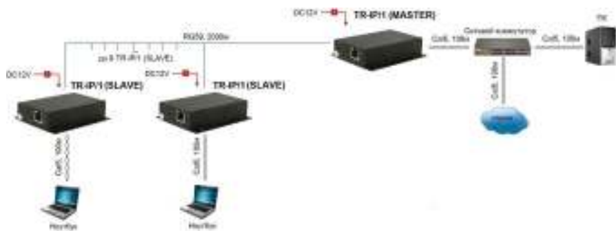
Рис. 3 Схема подключения TR-IP/1(MASTER) и TR-IP/1(SLAVE) для организации удаленного сегмента сети.
