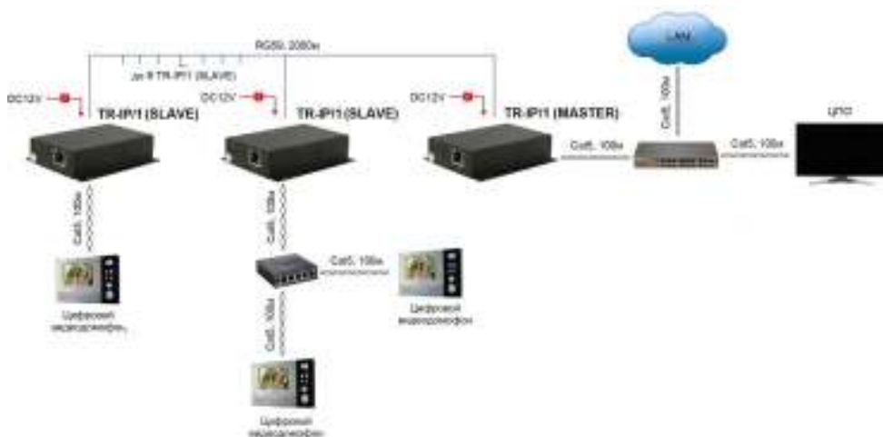
Рис. 6 Схема подключения TR-IP/1(MASTER) и TR-IP/1(SLAVE) для организации ЦПО.
