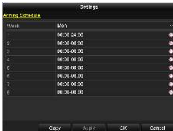
Рисунок 8-17 Установка расписания постановки на охрану тревожного выхода
