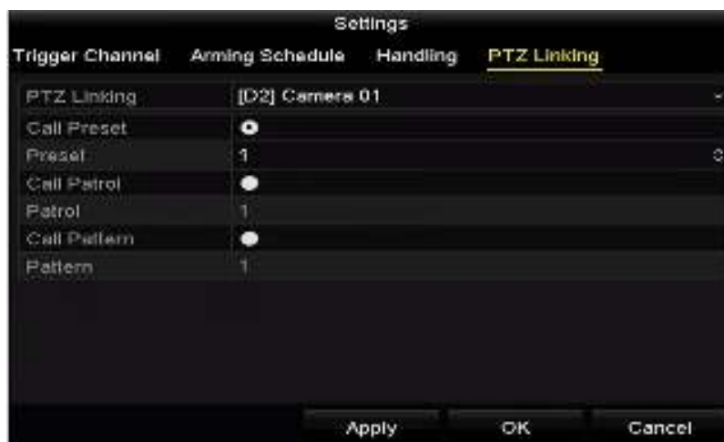
Рисунок 9-17 Установка привязки PTZ
