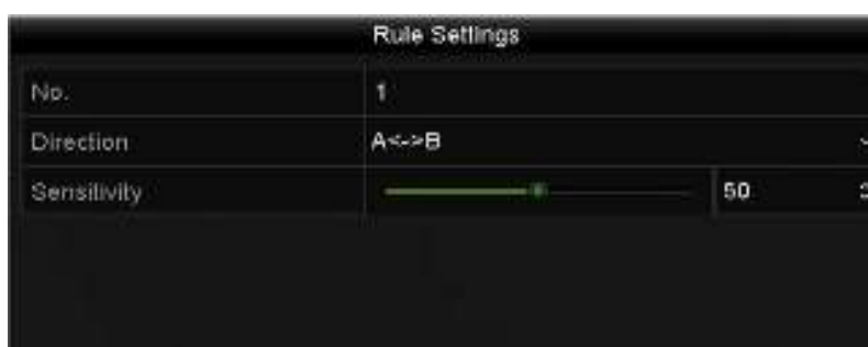
Рисунок 10-5 Установка правил обнаружения пересечения линии
