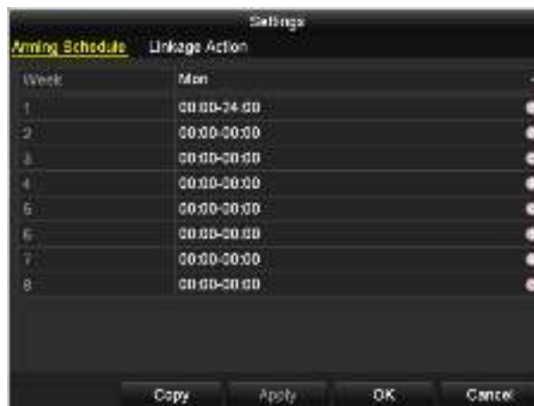
Рисунок 8-12 Установка расписания постановки на охрану тамперинга видео
