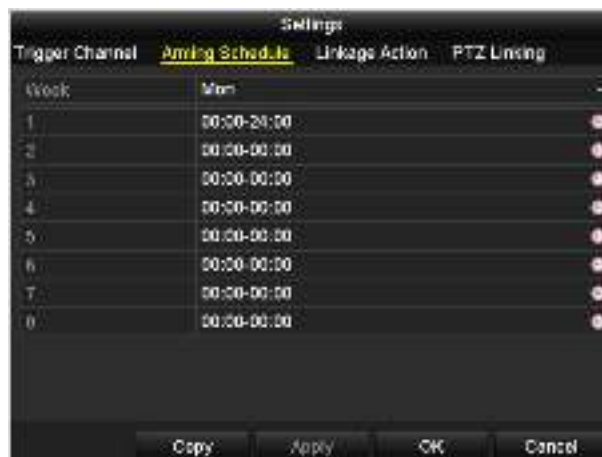
Рисунок 8-6 Установка расписания постановки на охрану тревожного входа
