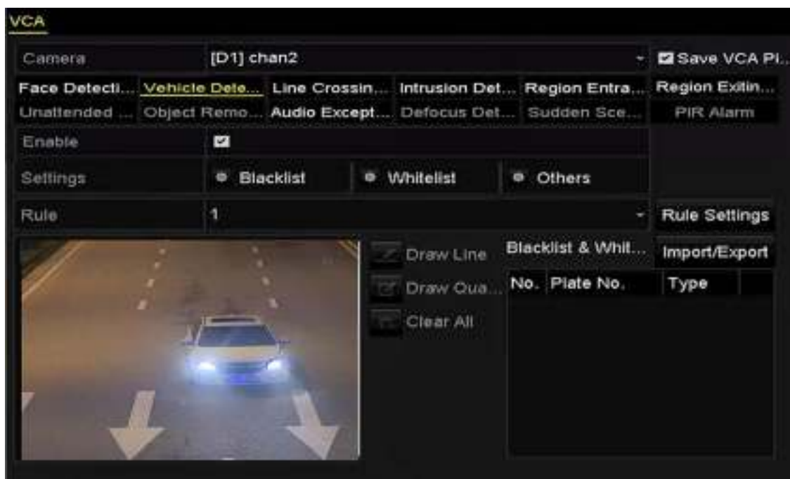
Рисунок 10-3 Установка обнаружения ТС
