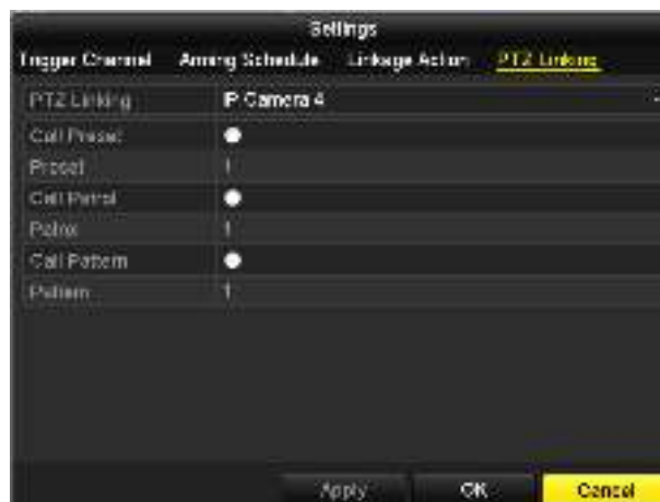
Рисунок 8-7 Привязка PTZ к тревожному входу
