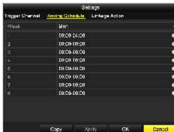
Рисунок 8-3 Установка расписания постановки на охрану обнаружения движения
