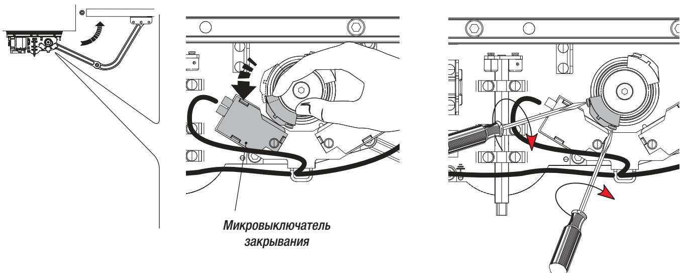
Откройте до конца створку ворот и вращайте другой кулачок по часовой стрелке до тех пор, пока не сработает микровыключатель открывания. Закрепите кулачок с помощью винтов.
