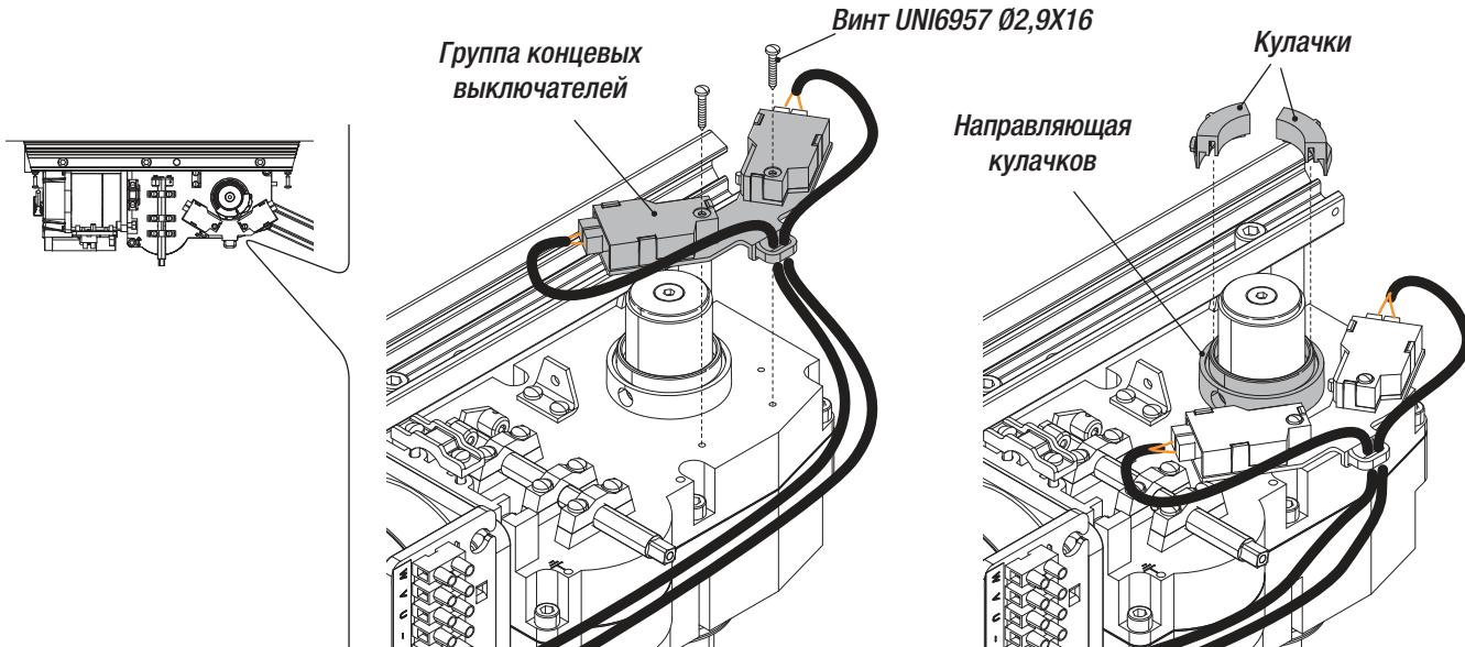
Полностью закройте створку левостороннего привода и вращайте кулачок против часовой стрелки до срабатывания микровыключателя закрывания. Закрепите кулачок с помощью винтов.
