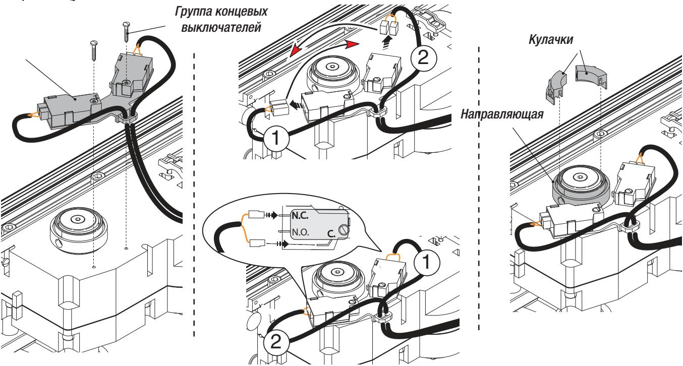
Полностью закройте створку левостороннего привода и вращайте кулачок по часовой стрелке до срабатывания микровыключателя закрывания. Закрепите кулачок с помощью винтов.
