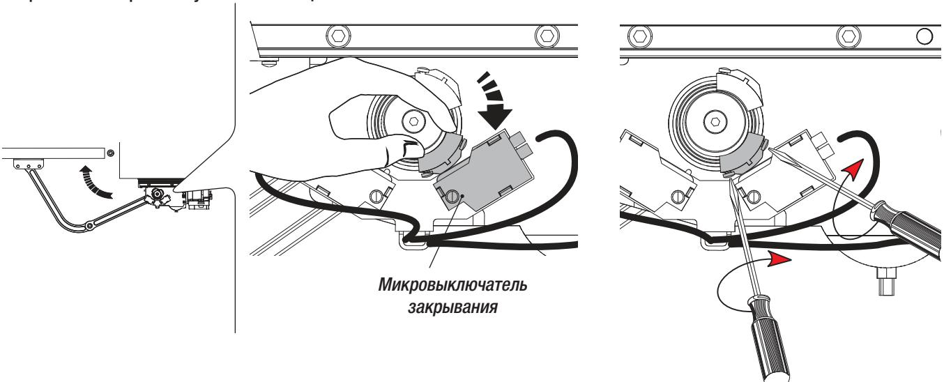
Откройте до конца створку ворот и вращайте другой кулачок против часовой стрелки до тех пор, пока не сработает микровыключатель открывания. Закрепите кулачок с помощью винтов.
