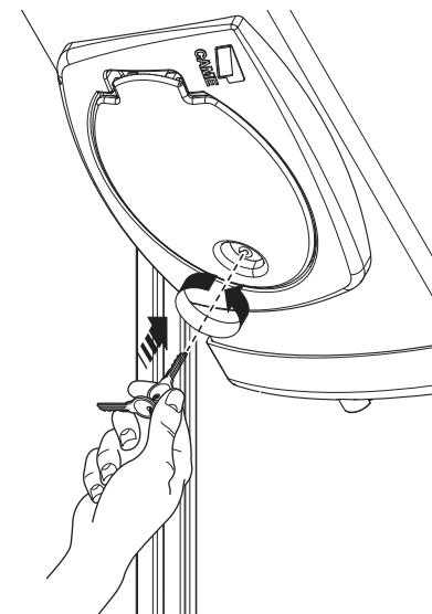
**Ручная разблокировка и блокировка привода**
