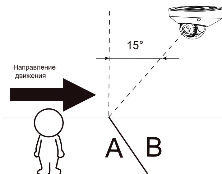
Для правильной работы функции подсчета объектов, рекомендуется выдерживать уклон оптической оси к плоскости посчета не более 15 °
