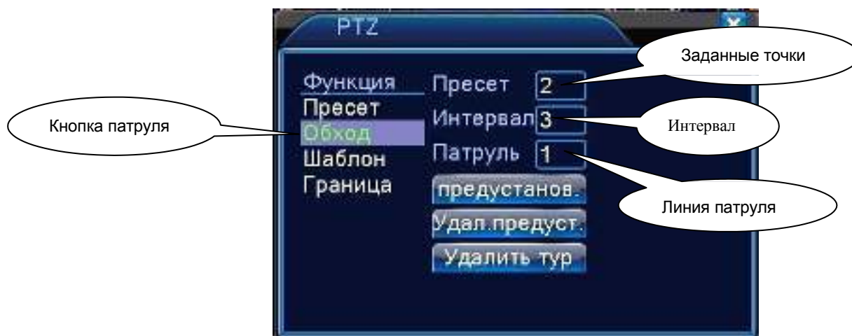
Рисунок 3.13 Настройки движения между точками
