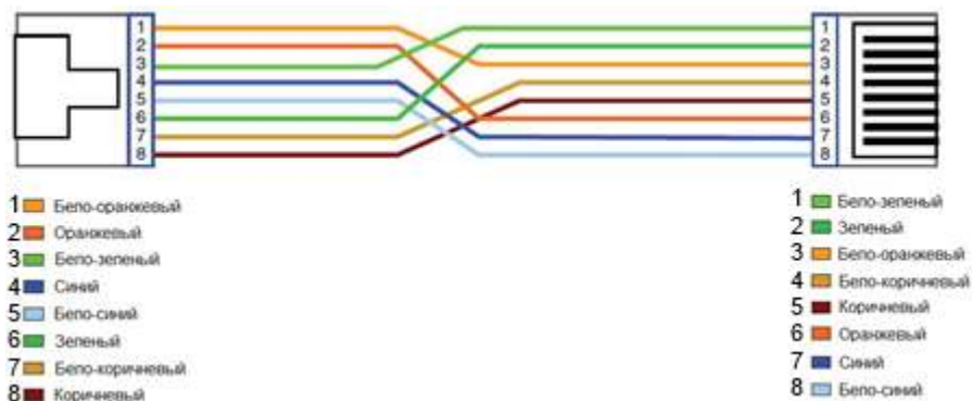
Рис. 12 Разводка кабеля по типу TIA/EIA-568-B.
