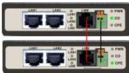
Рис. 8 Прямое соединение СО (сервера) и СРЕ (клиента).
