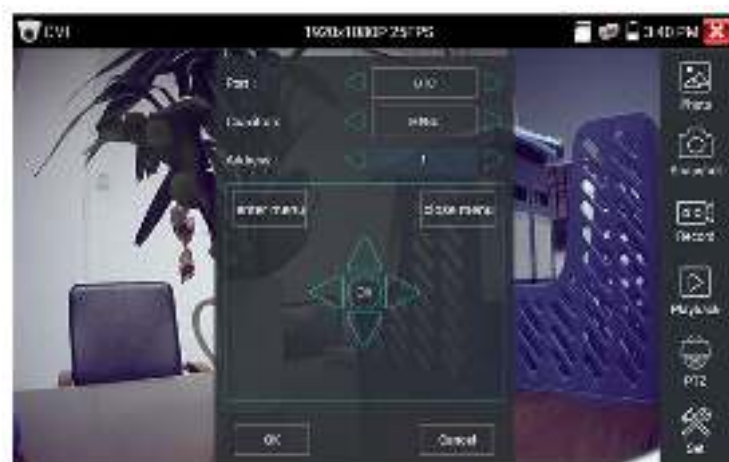
Рис.94 OSD меню PTZ CVI видеокамеры
