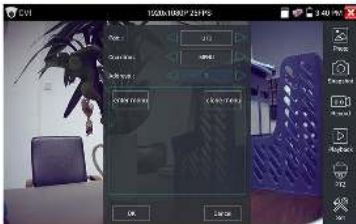
Рис. 93 Настройки для доступа к OSD меню видеокамеры по коаксиальному кабелю
