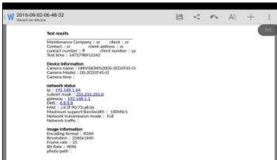
Рис. 56 Пример файла со сводной информацией об IP видеокамере
