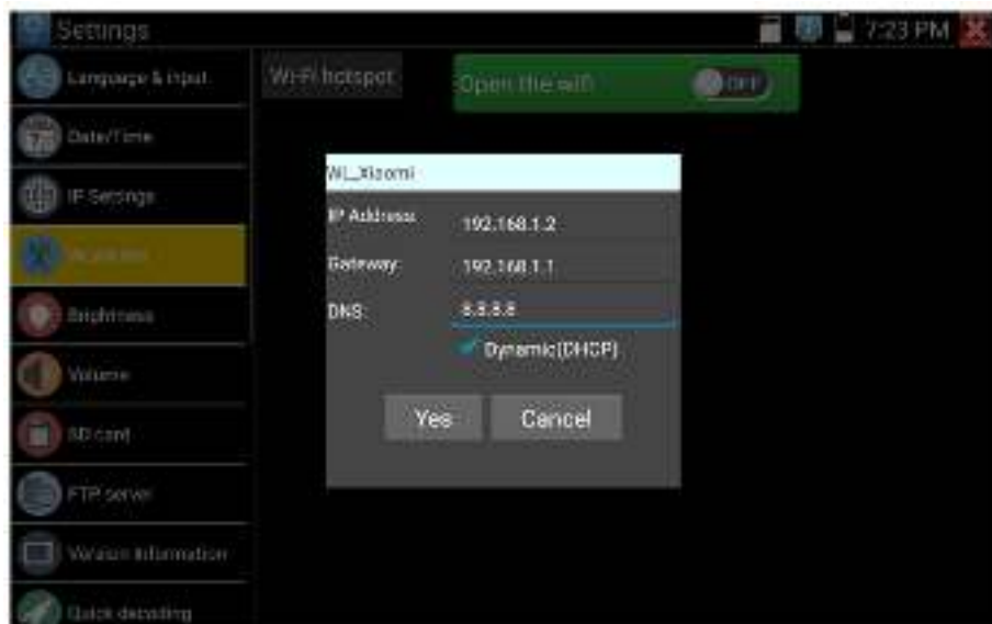
Рис. 163 Присвоение статического IP и тд. для выбранной беспроводной сети
