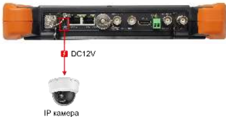
Рис. 9 Подключение питания к IP-видеокамере без PoE
