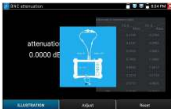
Рис. 123 Подключение кабеля для определения степени затухания
