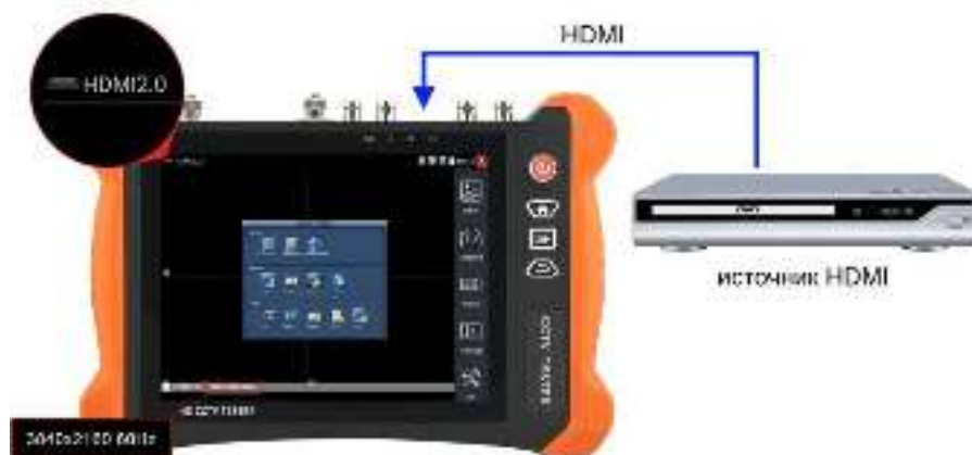
Рис. 14 Подключение HDMI устройств к тестеру.
