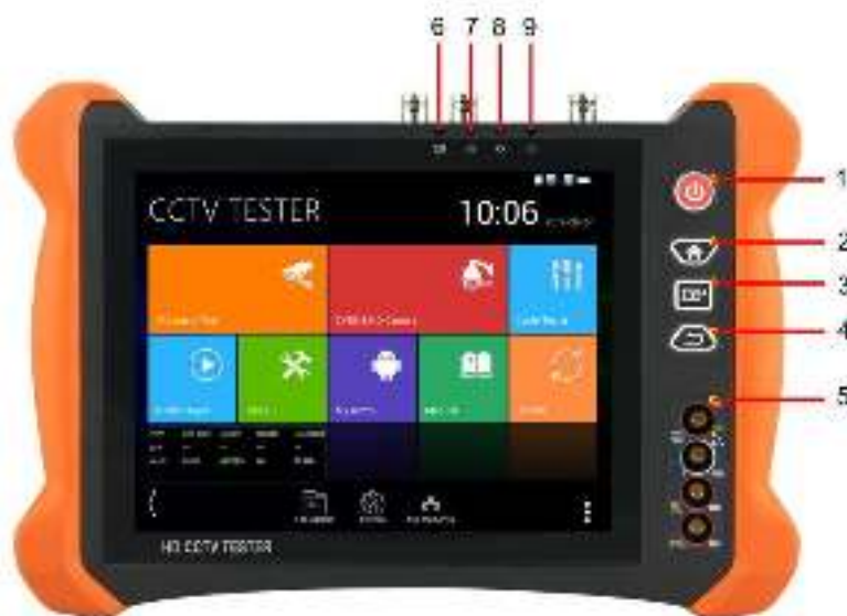
Рис. 4 Тестер TIP-HOL-MT-8, разъемы, кнопки и индикаторы на передней панели
