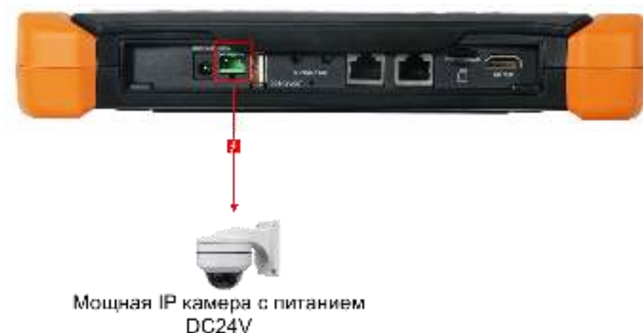
Рис. 10 Подключение питания к мощной IP-видеокамере без PoE
