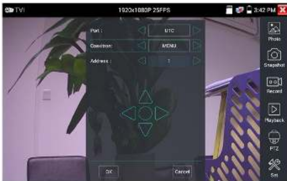
Рис.97 OSD меню PTZ TVI видеокамеры
