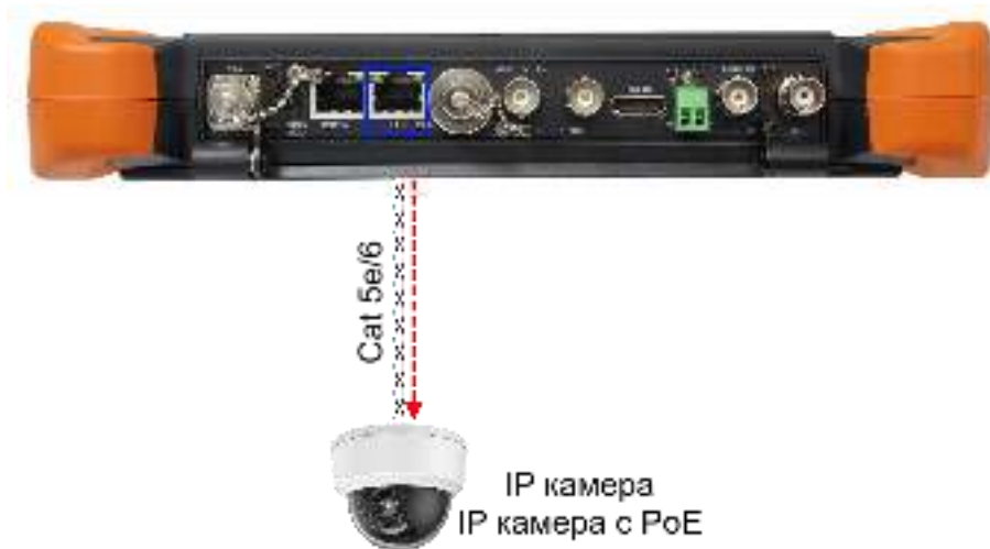
Рис. 7 Подключение IP-видеокамеры к тестеру
