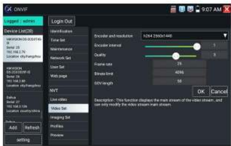
Рис. 37 Настройки видеопотока для IP видеокamеры
