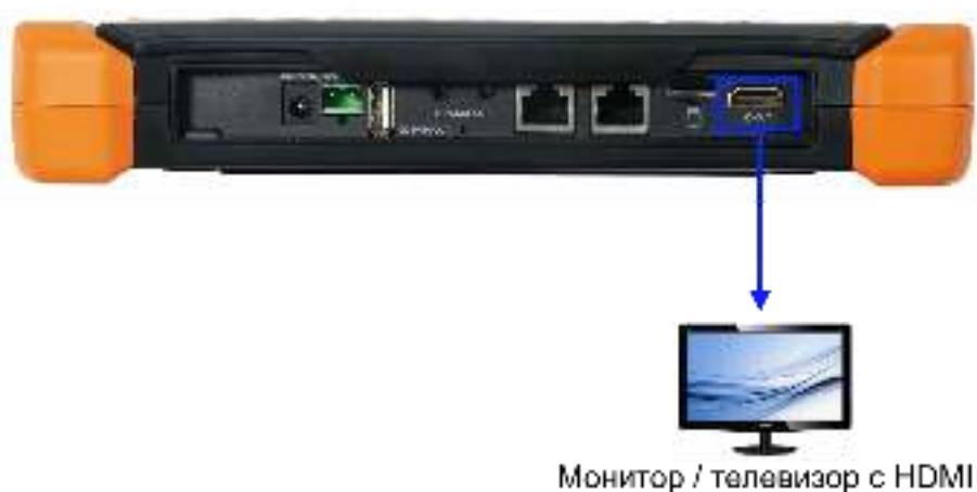
Рис. 15 Подключение тестера к HDMI-монитору
