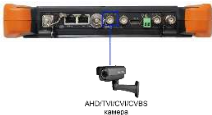
Рис. 12 Подключение AHD/TVI/CVI/CVBS видеокамеры к тестеру
