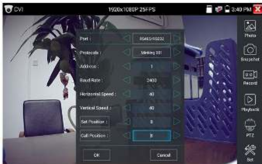
Рис.92 Управление PTZ CVI видеокамерой по интерфейсу RS232/485
