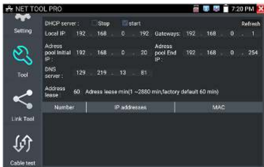
Рис. 109 Инструмент для назначения временных адресов устройствам в сети «DHCP сервер»
