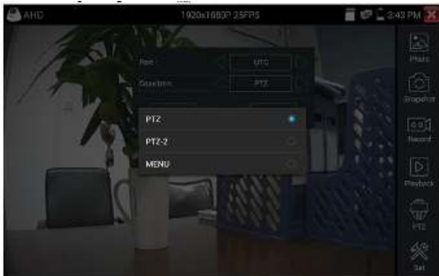
Рис.99 Выбор настроек для управления AHD PTZ видеокамерой по коаксиальному кабелю
