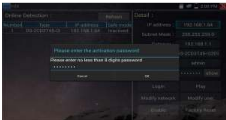
Рис. 141 Ввод пароля для активируемой видеокамеры Hikvision
