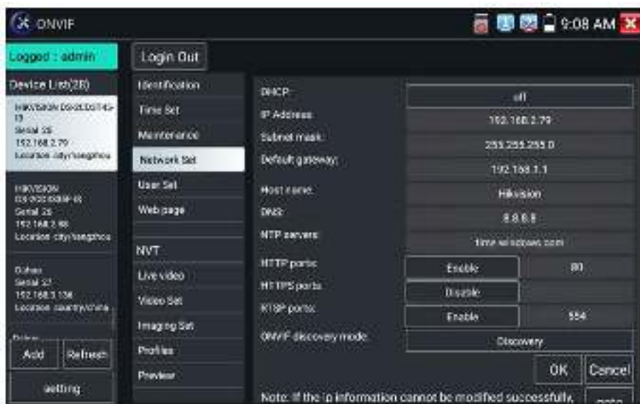
Рис. 44 Сетевые настройки IP видеокamеры
