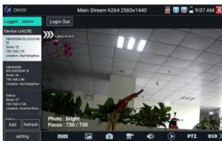
Рис. 36 Управление PTZ IP видеокамерой по ONVIF
