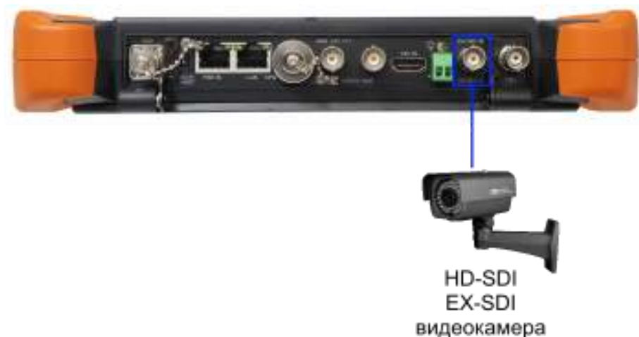
Рис. 13 Подключение EX SDI / HD SDI видеокамеры к тестеру
