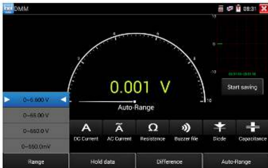
Рис. 128 Настройка ручного или автоматического диапазона измерений
