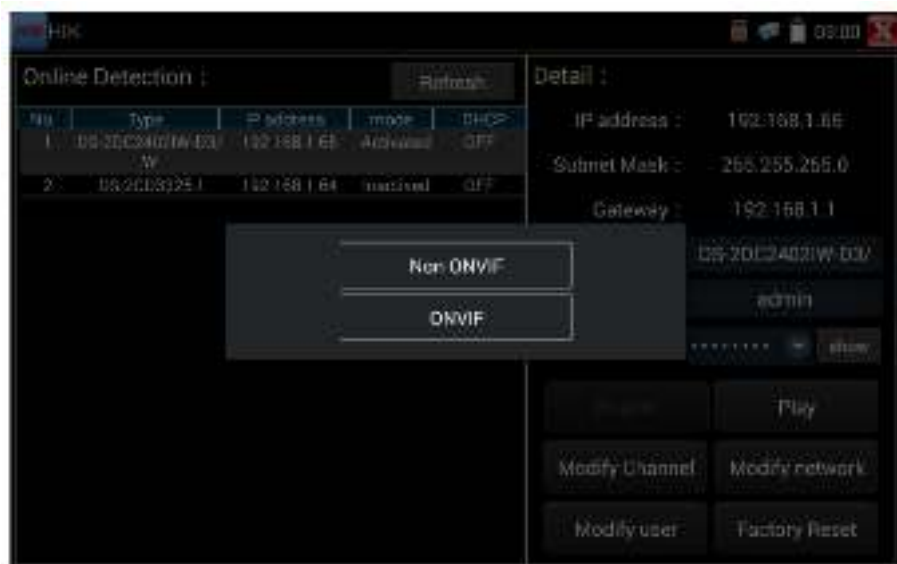
Рис. 142 Завершение активации видеокамеры Hikvision
