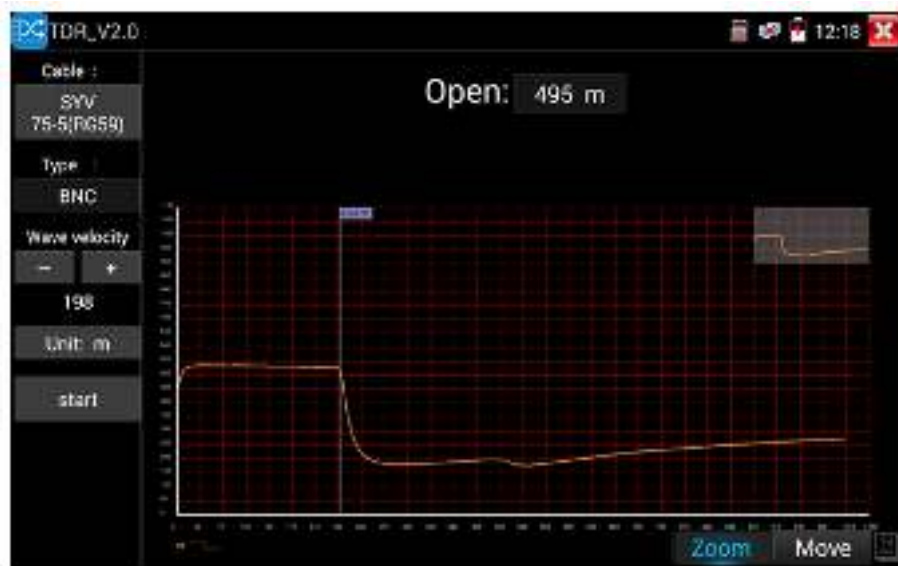
Рис. 120 Рефлектометр (TDR) для коаксиального кабеля, интерфейс
