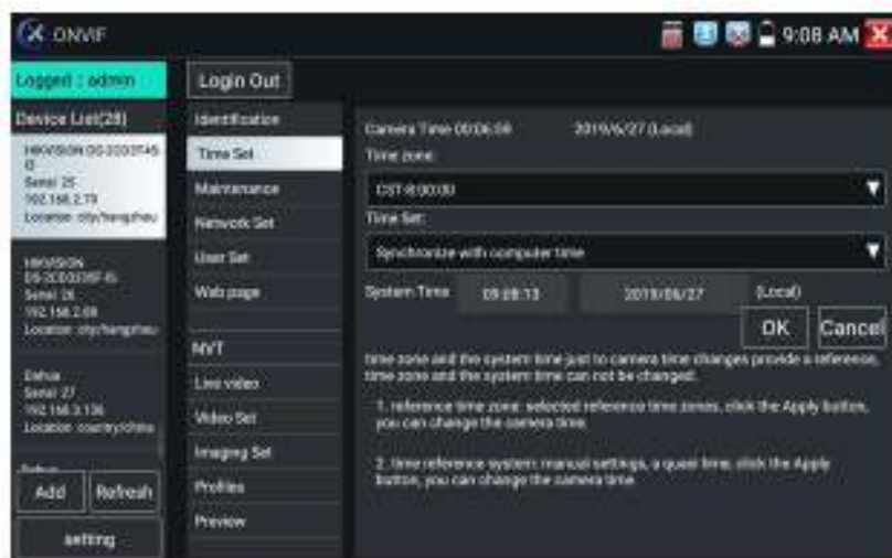
Рис. 41 Установка времени для IP видеокамеры
