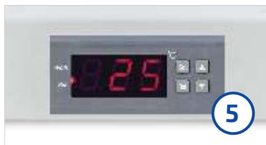
После включения нажмите кнопку **Set** один раз для ввода температуры срабатывания контроллера. При этом загорится световой индикатор.
