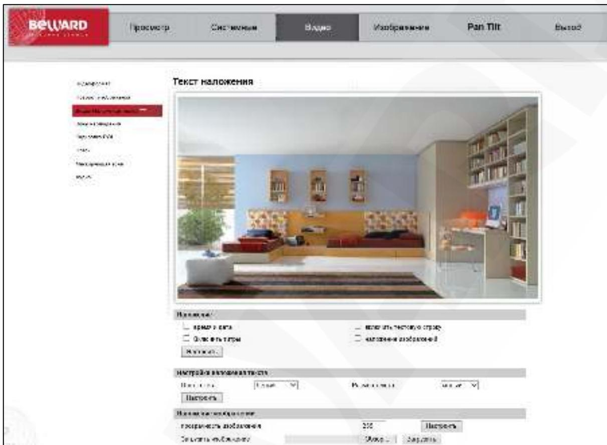
**Наложение (Overlay type):** в данном разделе выбирается информация, которая будет отображаться в текстовом виде, наложением на изображение. Доступны следующие значения: время и дата (в форматах ГГГГ/ММ/ДД и ЧЧ:ММ:СС), включить титры (длиной до 15 символов), включить текстовую строку (текст написанный в ручную длиной до 15 символов), наложение изображений.
