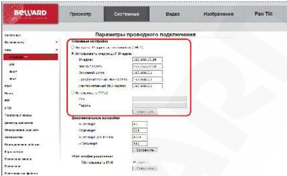
**Получить IP-адрес автоматически (DHCP) (Get IP address automatically):** устанавливает автоматическое получение основных сетевых параметров от DHCP-сервера. Для работы этой функции необходимо наличие в сети DHCP-сервера.
