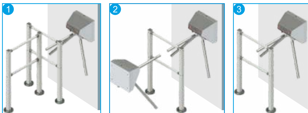
1 2 3 -турникет установлен правильно
