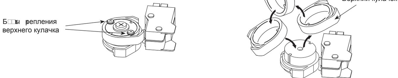
При разблокированном приводе вручную полностью закройте створку ворот, поверните верхний кулачек по часовой стрелке до тех пор, пока микропереключатель не разомкнется, как показано на рисунке, и закрепите его с помощью болтов.
