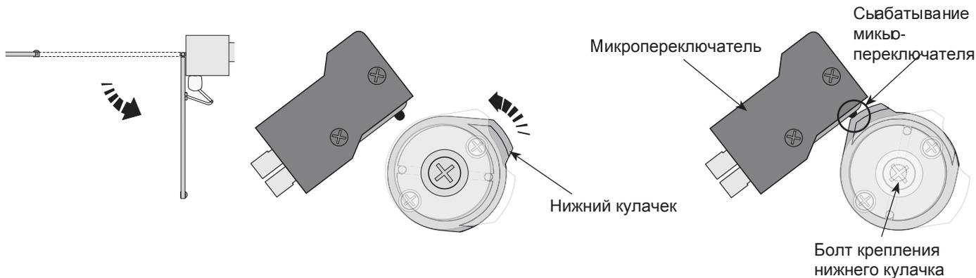
Для замедления створки перед конечным положением (смотрите инструкцию на ZL180, параграф 6.2, переключение микропереключателей), вручную передвиньте створку в полностью открытое положение (макс. 100°). Поверните нижний кулачек против часовой стрелки до тех пор пока переключатель не разомкнется. Закрепите его, используя центральный болт.
