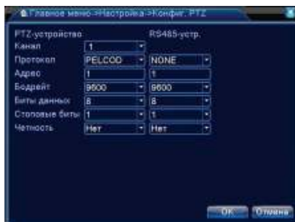
Рисунок 4.32 Конфигурация PTZ и RS485 устройств в аналоговом и гибридном режимах.
