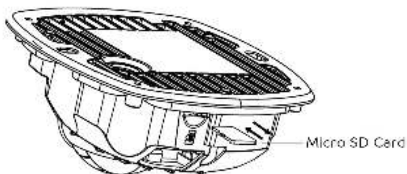
Рисунок 11. Установка карты памяти в слот камеры
