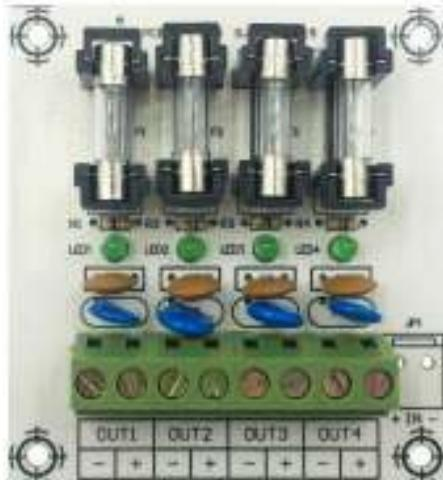
Модуль на 4 выходных канала ST-PS104FB предназначен для расширения базового функционала источников питания ST-PS103, ST-PS105, ST-PS103B-BK, ST-PS103C-BK, ST-PS105C-BK, ST-PS105D-BK, ST-PS110E-BK и ST-PS110F-BK. Устройство позволяет получить 4 выходных канала, каждый из которых защищен отдельным предохранителем.
