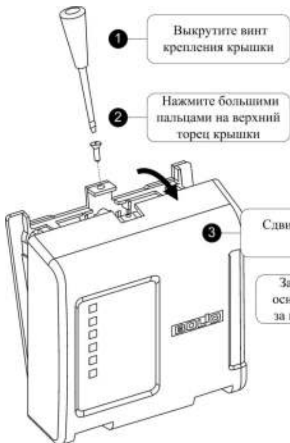
Рисунок 2.2.2 – Снятие крышки корпуса блока
