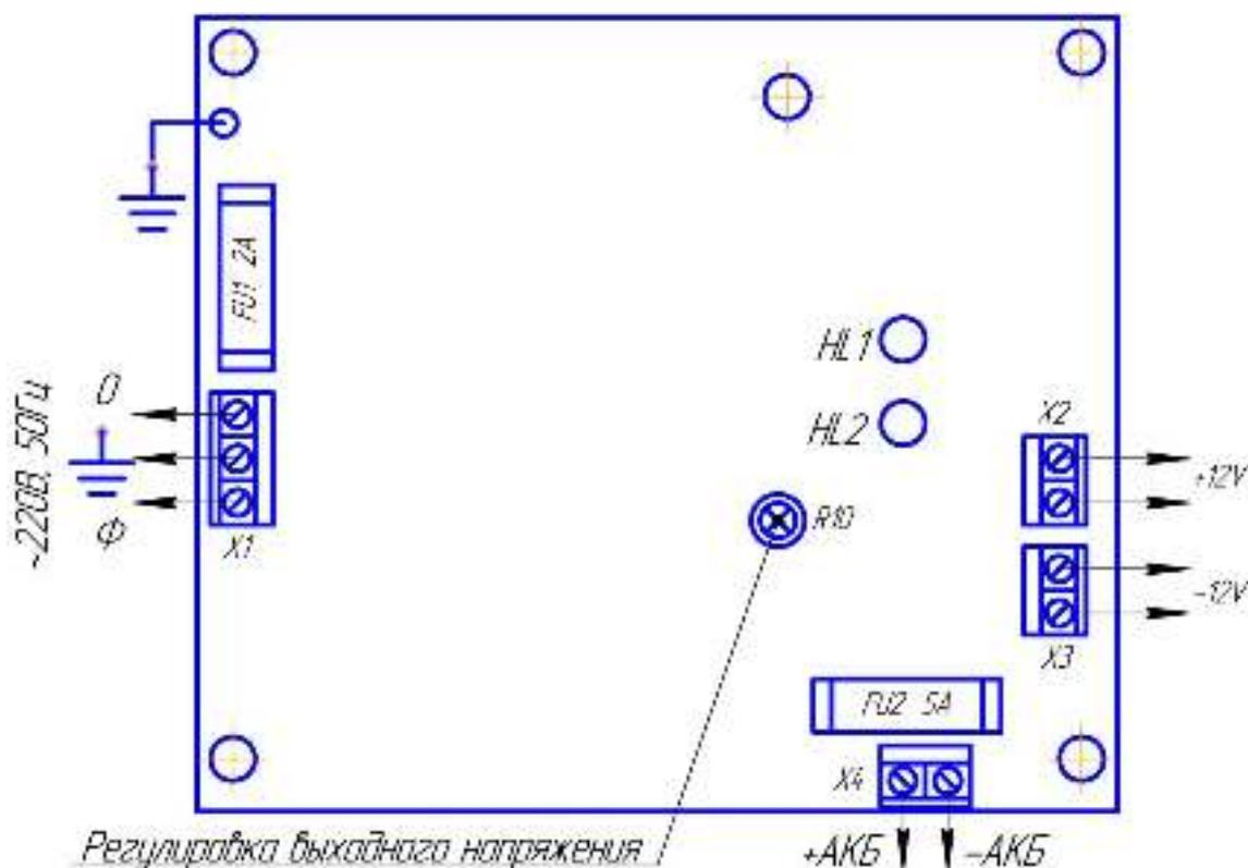
При длительном отключении ББП (более суток) и при снятом напряжении 220В, целесообразно отключить аккумулятор, сняв клемму «+».
