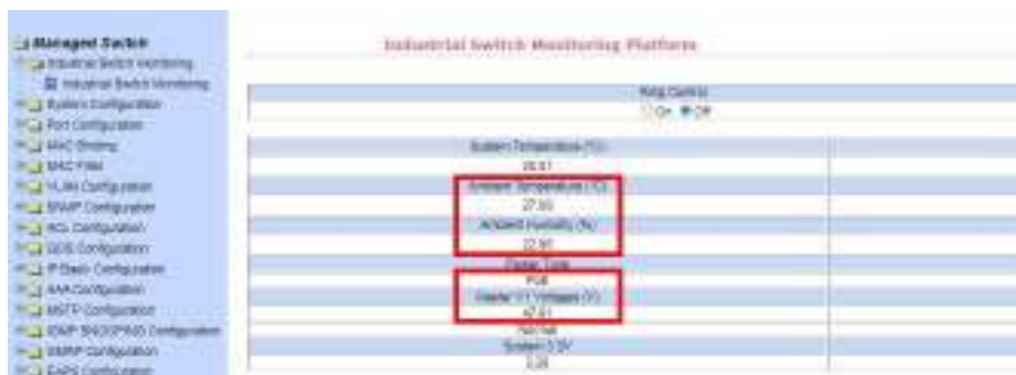
Рис.7 Контроль температуры/влажности, напряжения питания через WEB-интерфейс коммутатора
