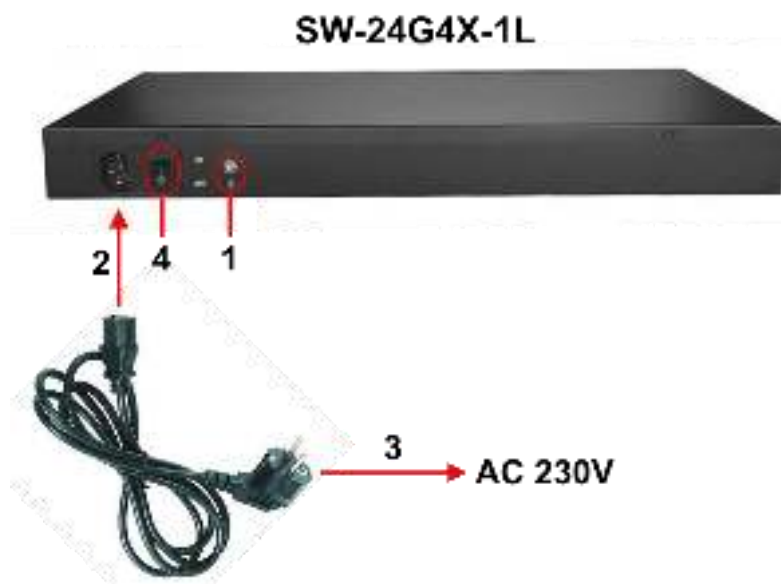
Рис. 6 Подключение коммутатора к сети AC 230V
