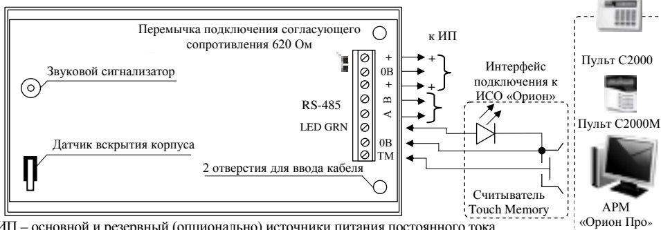
Рисунок 3. Схема внешних соединений блока
