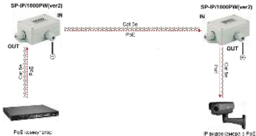
Рис.3 Типовая схема подключения устройства грозозащиты SP-IP/1000PW(ver2)
