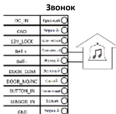
Рисунок 3-2 Схема подключения звонка
