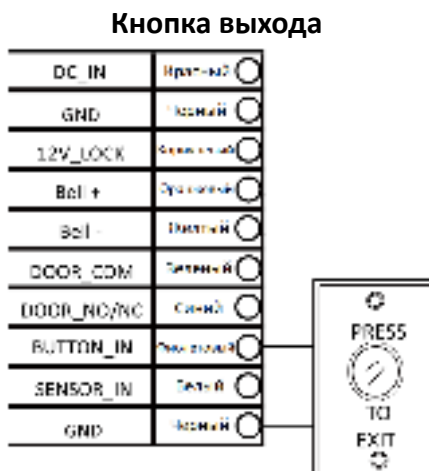
Рисунок 3-3 Схема подключения кнопки выхода
