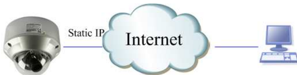
Рис.3.5.2 Подключение напрямую со статическим IP
