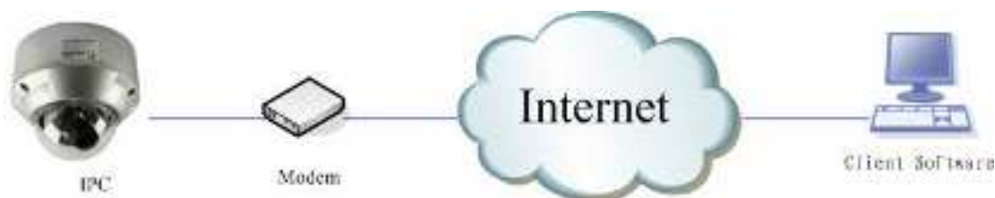
Рис.3.5.4 Подключение камеры с использованием PPPoE dial-up
