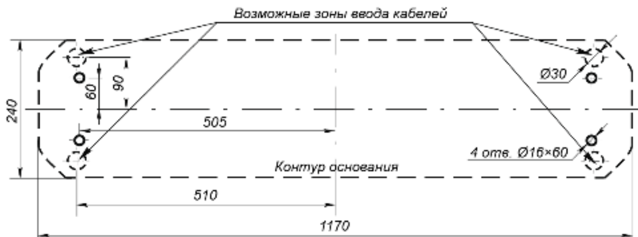
Рисунок 12. Схема разметки для установки стойки турникета 1
