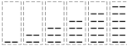
Рисунок 4 - Графическое отображение процесса заряда АКБ на ЖК-дисплее.
