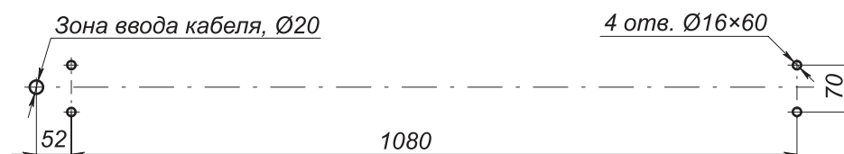
Разметка отверстий для монтажа калитки
