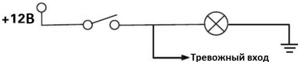
Схема подключения тревожного выхода:
