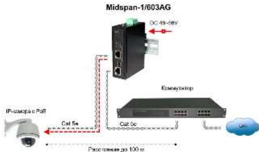
Рис.4 Типовая схема подключения инжектора Midspan-1/603AG
