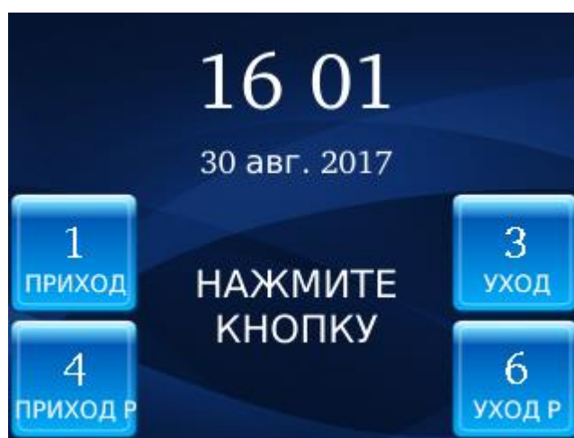
Рисунок 12. Экран терминала в режиме «Кнопка входа/выхода + код группы + ладонь/карта»
