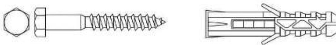
Рисунок 7.4.1 Шуруп с шестигранной головкой «Глухарь» с дюбелем
