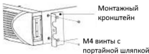
Рисунок 2-6. Установка монтажных кронштейнов
