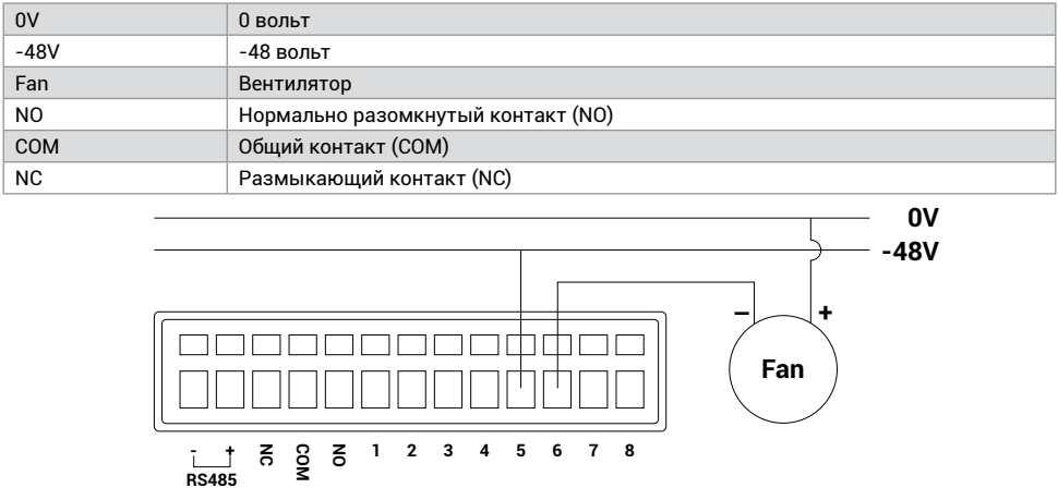
Рис. 2.3 Схема подключения интерфейса постоянного тока
