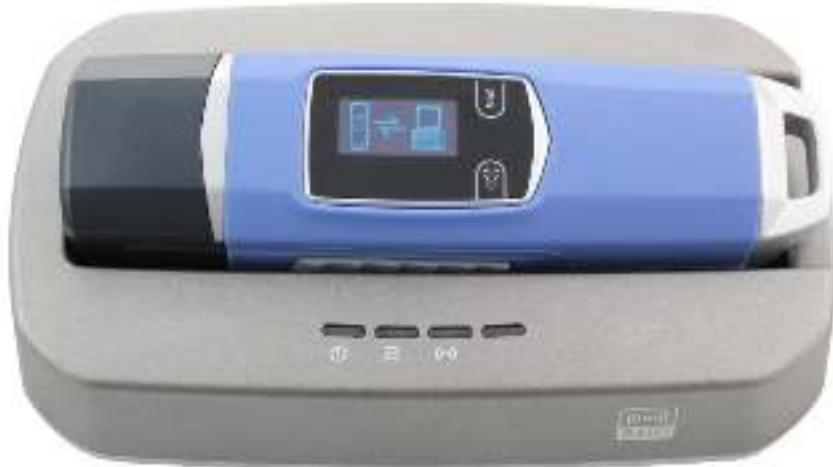
Док-станция ST-CE058EM предназначена для реализации беспроводной передачи данных между носимым терминалом контроля маршрутов ST-CT058EM и компьютером с приложением «Таймекс». Док-станция осуществляет беспроводную передачу данных и имеет встроенный считыватель EM идентификаторов, который может использоваться для программирования контрольных точек в программе «Таймекс». ST-CE058EM является инструментом повышения производительности и упрощает считывание данных и программирование системы.
