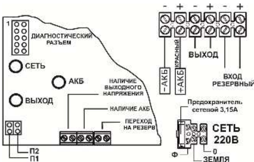
Рисунок 1. Вид источника с открытой крышкой (схема подключения)
