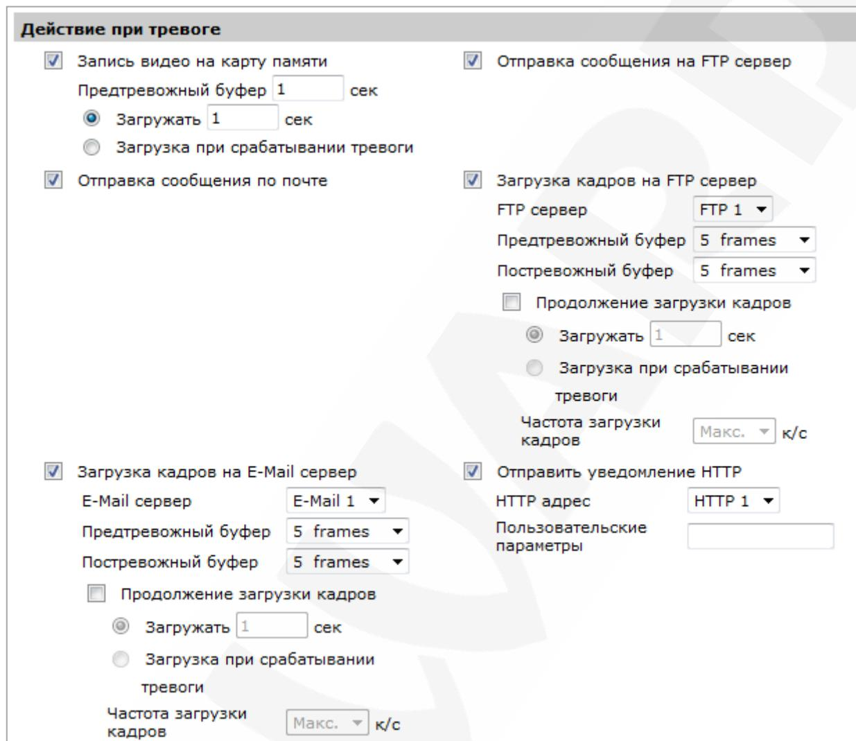
Настройка реакции при обнаружении вмешательства аналогична настройке реакции при срабатывании детектора движения, рассмотренной в пункте [4.10.2](#) данного Руководства.
