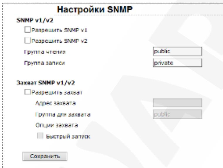
**Разрешить SNMP v1 (Enable SNMP v1):** использовать протокол SNMP версии 1.
