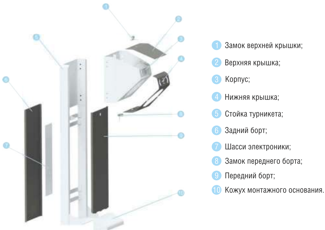
Рисунок 6.1.1 Устройство корпуса турникета
