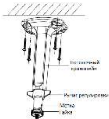
Рисунок 2-4 Установка монтажного кронштейна
