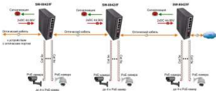
Рис.6 Типовая схема подключения коммутатора SW-8042/IF
