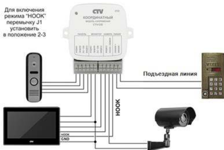
Рисунок 4 — Использование сигнала HOOK
