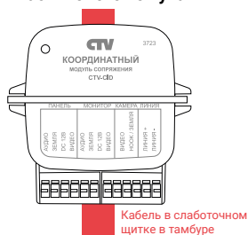
Рисунок 5 — Монтаж модуля сопряжения
