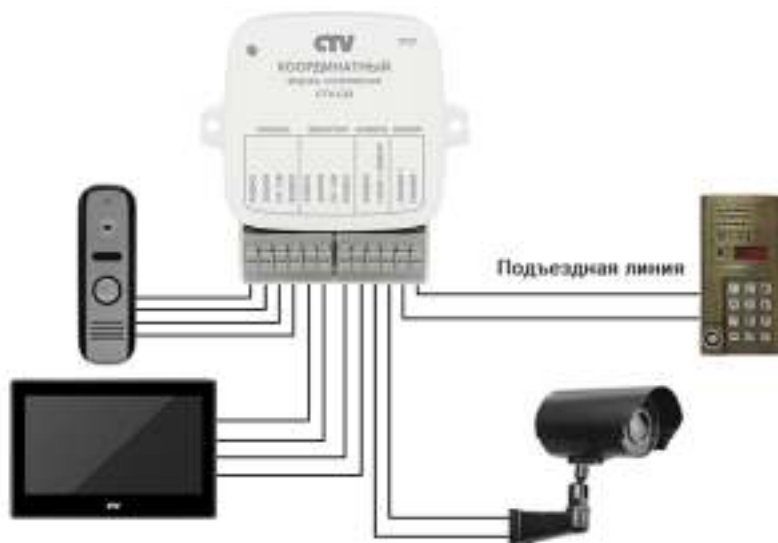
Рисунок 3 — Подключение компонентов домофонной системы
