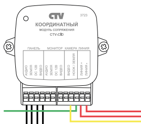
Рисунок 5 — Монтаж модуля сопряжения
