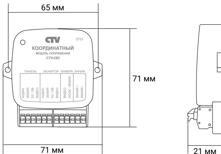
Рисунок 2 — Размеры модуля сопряжения
