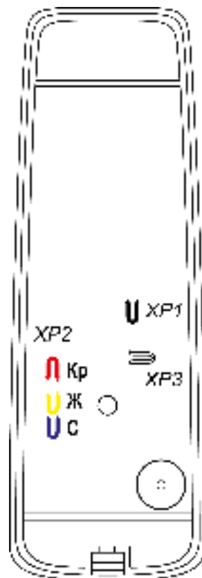
Рисунок 3. Расположение трех перемычек «Конфигурация» ( XP2 ), перемычек «Отключение концевого резистора» ( XP1 ) и «Тип выходного интерфейса» ( XP3 )
