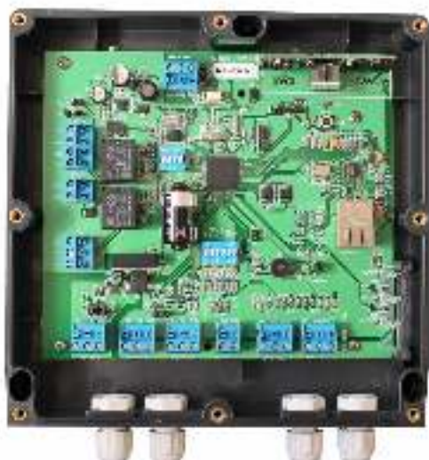
Рисунок 1. Открытый корпус с платой контроллера
