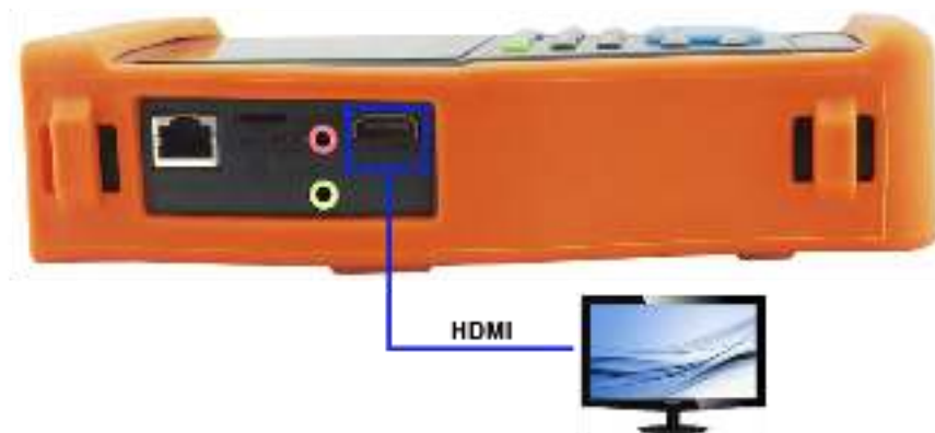
Рис. 11 Подключение тестера к HDMI-монитору
