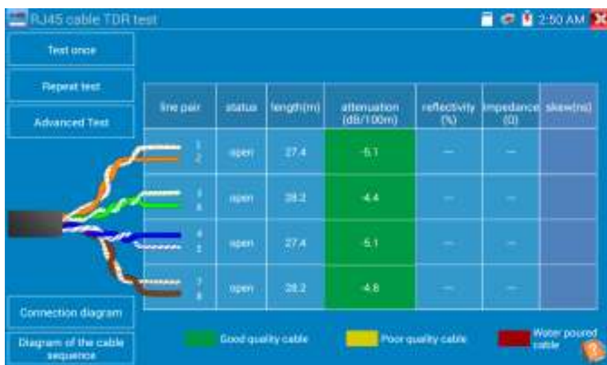
Рис. 103 Детальный тест кабеля (Advanced test)
