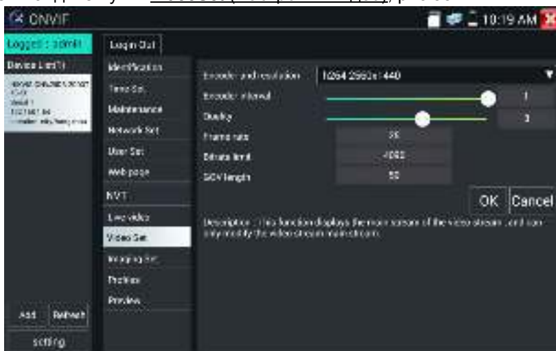
Рис. 33 Настройки видеопотока для IP видеокамеры
