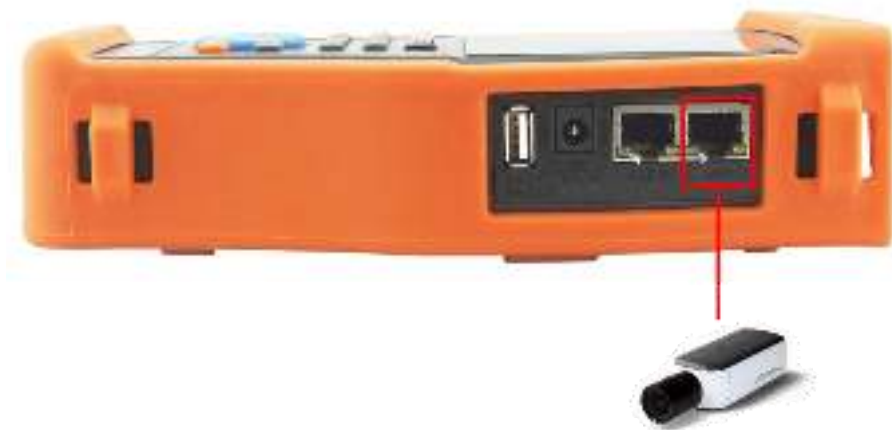
Рис. 5 Подключение IP-видеокамеры к тестеру
