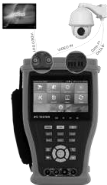
Рис. 8 Подключение CVBS видеокамеры к тестеру
