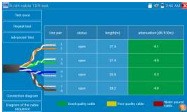
Рис. 102 Интерфейс рефлектометра (TDR) для кабеля «витой пары»
