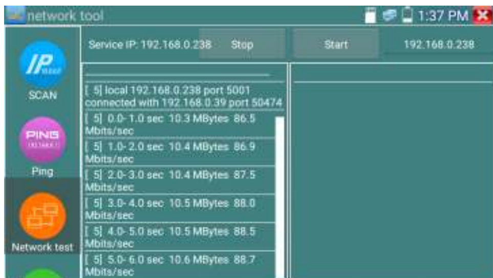
Рис. 89 Работа 1го тестера в режиме «сервер» при проверки пропускной способности сети
