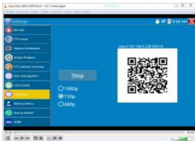
Рис. 22 Пример трансляции изображения на ПК с тестера с помощью VLC плеера
