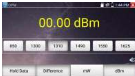
Рис. 118 Использование функции удержания последнего измерения и измерения относительной мощности
