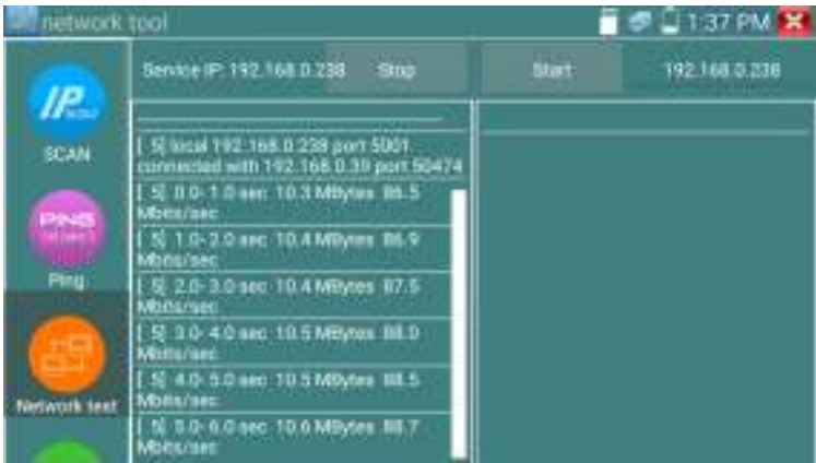
Рис. 92 Результаты тестирования пропускной способности, ПК в качестве клиента.
