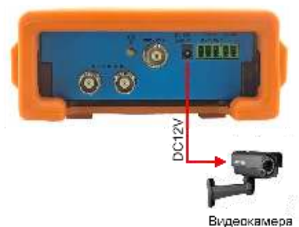
Рис. 7 Подключение питания к IP-видеокамере
