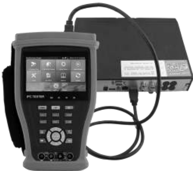
Рис. 10 Подключение HDMI устройств к тестеру.
