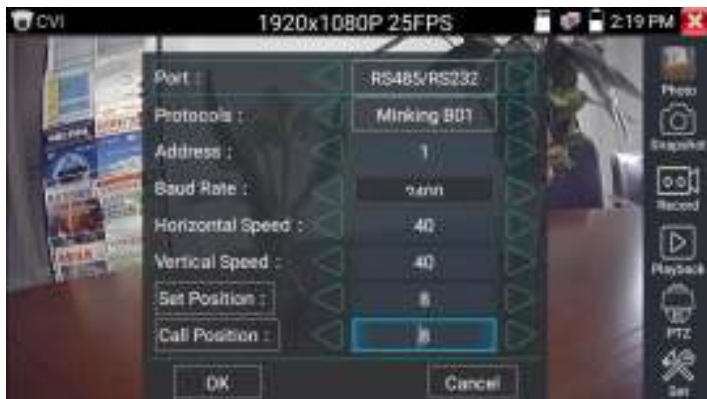
Рис.80 Управление PTZ CVI видеокamerой по интерфейсу RS232/485
